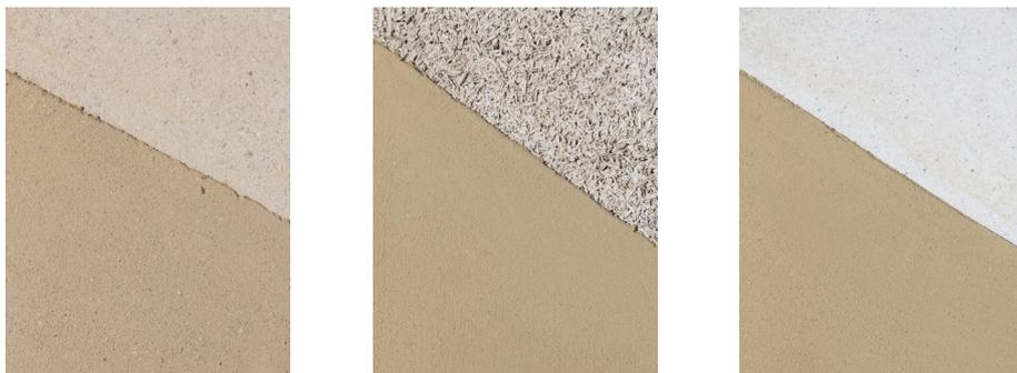
Exemples d'Enduits d'argile de Léém sur des supports appropriés : Blocs comprimés de Léém, blocs de béton de chanvre et plaques de plâtre armé (Fermacell)
