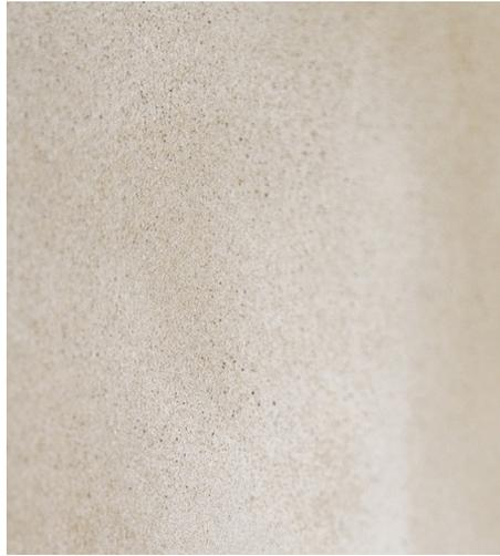
Résultat final d'une finition en Enduit d'argile fin de Léém lissée
