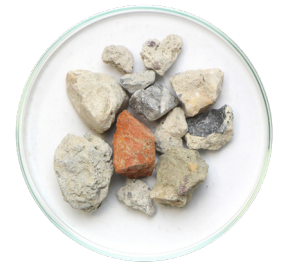
Béton broyé et lavé
