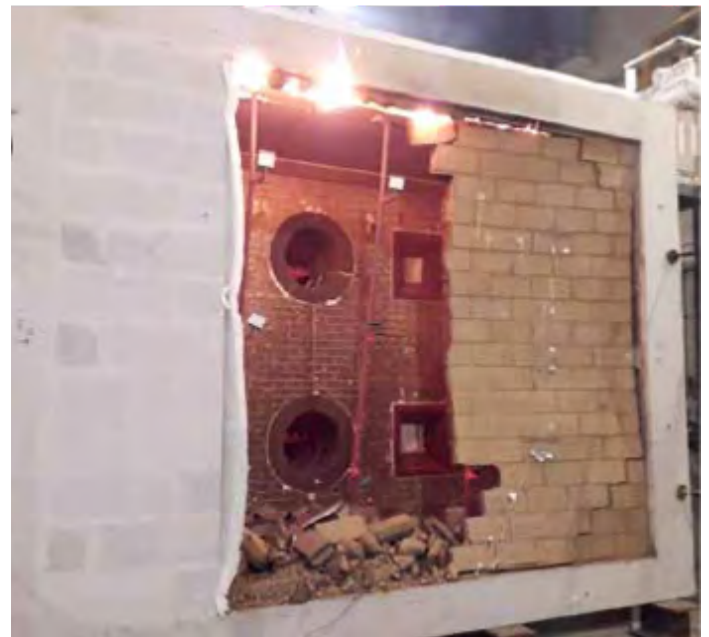
Brandweerstandstest bij CERIB op metselwerkwand in leemsteen van 9,5 cm dikke voor en na 50 minuten brandblootstelling [ 7 ] ( p.160 )
