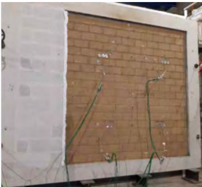
Brandweerstandstest bij CERIB op metselwerkwand in leemsteen van 9,5 cm dikke voor en na 50 minuten brandblootstelling [ 7 ] ( p.160 )
