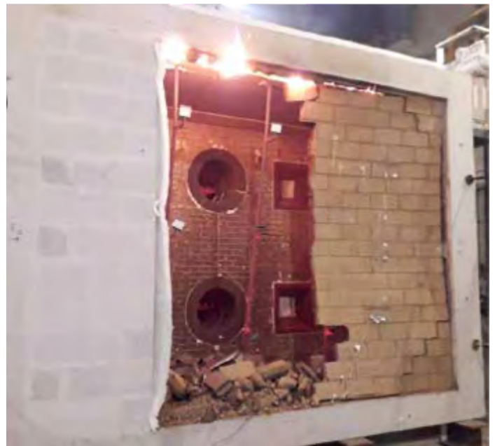
Mesure de la résistance au feu au CERIB sur une paroi BTC de 9,5 cm d'épaisseur : avant et après 50 minutes d'exposition au feu [ 7 ] ( p.160 )
