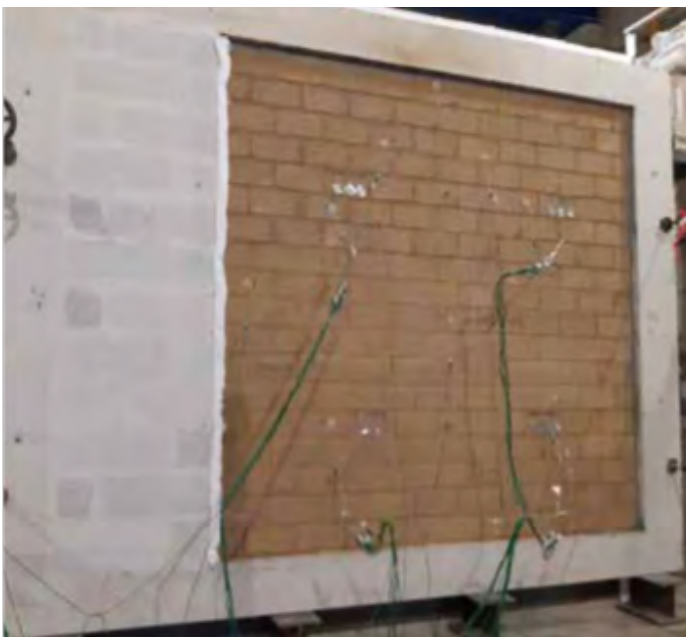
Mesure de la résistance au feu au CERIB sur une paroi BTC de 9,5 cm d'épaisseur : avant et après 50 minutes d'exposition au feu [ 7 ] ( p.160 )
