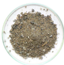
Béton broyé et lavé
